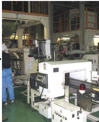
袋詰めされた学校給食米は最後に金属検知機を通過して出荷します。
