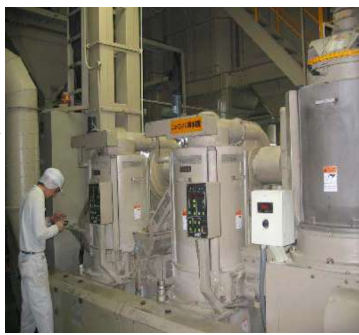
玄米を精米にする精米機です。適正に加工できたかチェックしています。
